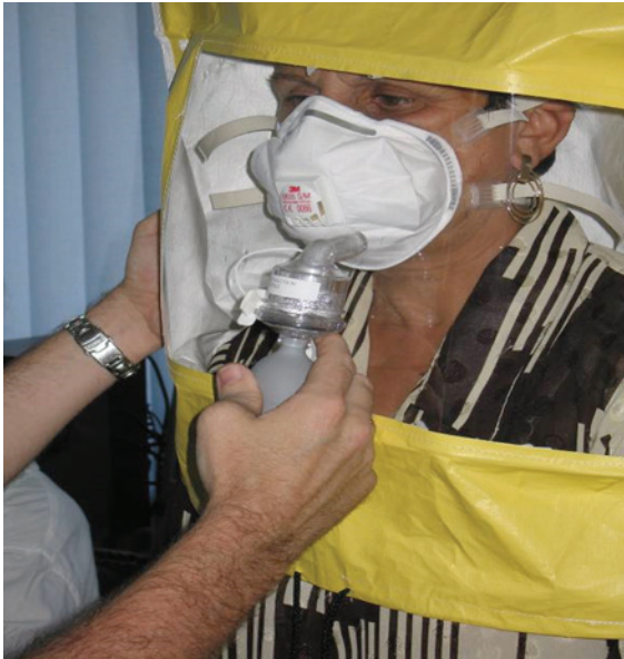
Նկ. 9. Կիպ նստեցման որակական թեստի օրինակ
